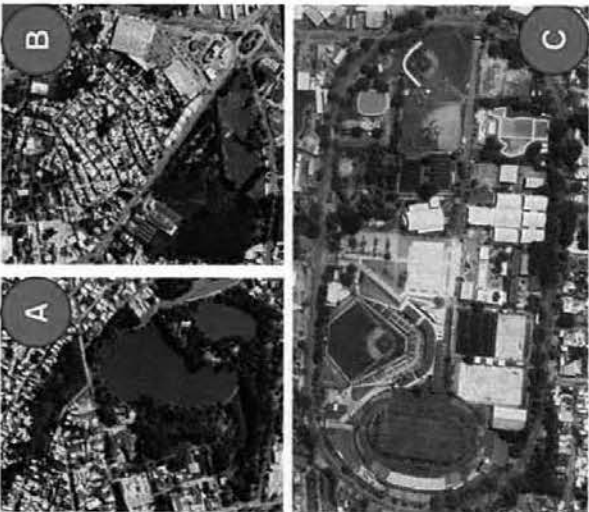
Figura 76. A) Laguna del parque La Pólvera. En la parte norte de la imagen se puede apreciar el vaso de captación de la cuneta que funciona como un tanque de sedimentación antes de dirigir su cau- dal hacia el río. B) Vaso regulador y campo deportivo Guayabal/Puerto a las instalaciones del Guayabal Polanco las oficinas de Seguridad Pública. C) Estadio Olímpico y Parque Camarero 27 de febrero (Fuente de las imágenes Google Earth, 2023).
